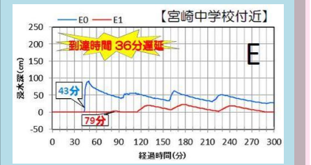
◆図Ⅱ：水際施設の「粘り強い構造化」後のL2津波
