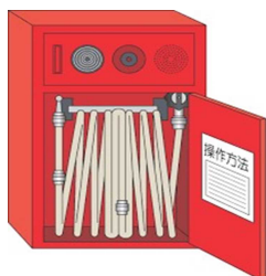
屋内消火栓設備
