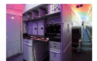
ギャレー (厨房設備) 機内の限られた空間で乗務員が効率よく使いこなせるデザインや機能、耐久性が求められます。
