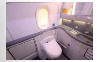
ラバトリー (化粧室) 機内唯一のプライベート空間として、質感、機能を追求。高い軽量化技術も駆使しています。
