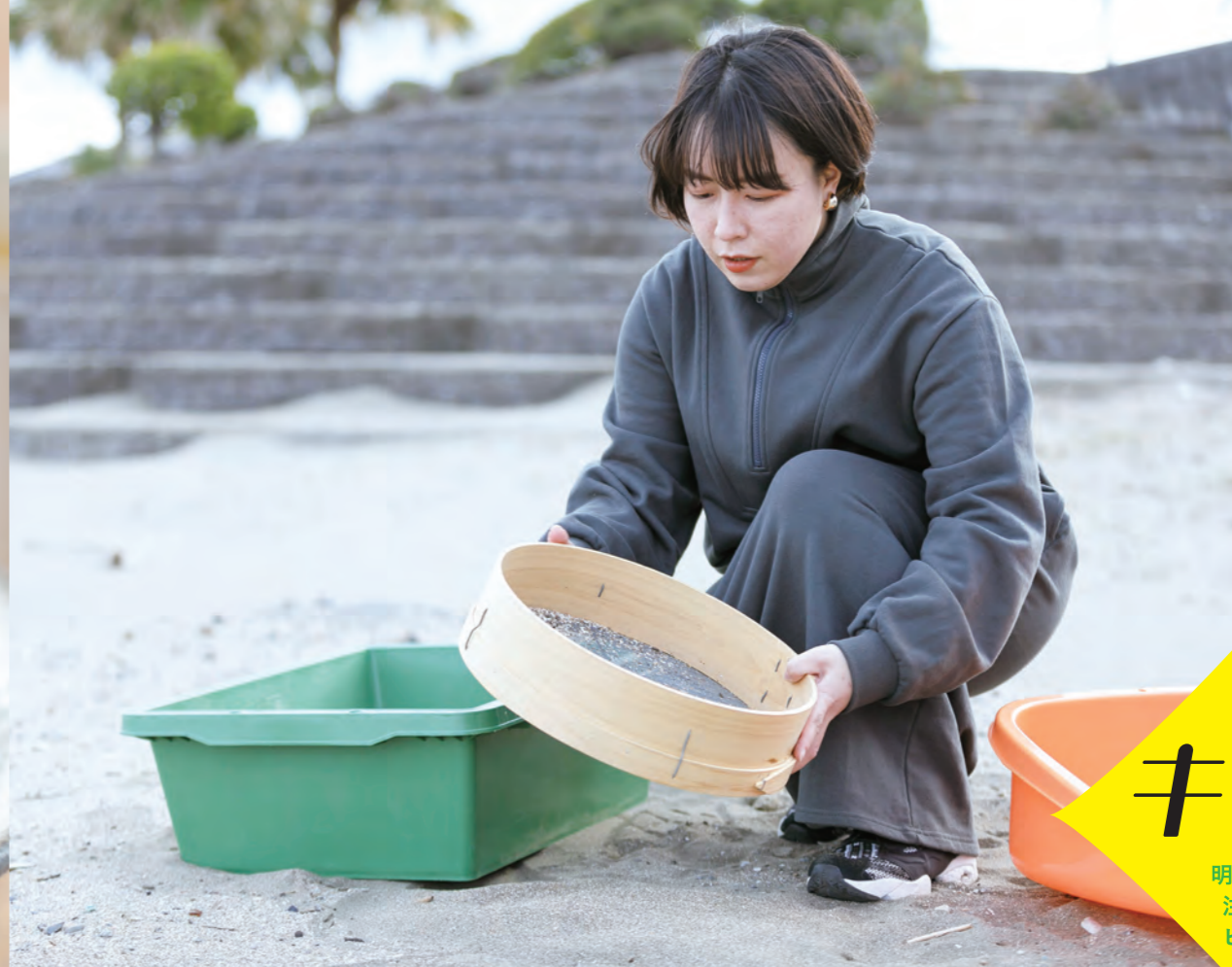
砂浜でふるいにかけて5mm以下のものを持ち帰る。持ち帰ったものは木片などを取り除き、さらに4種類のMPsに分類して数を数えるため、作業に根気が必要だ。
