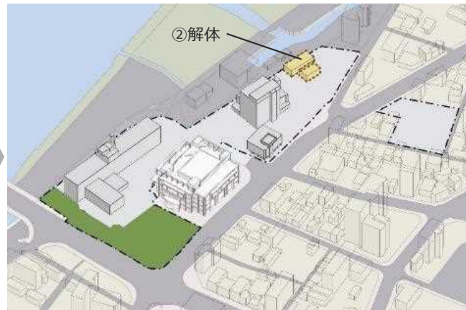
②会議室棟を解体し、新庁舎1期棟の建設用地を確保。
