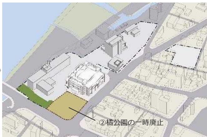
②橋公園の一部を一時的に廃止して仮設庁舎の建設用地を確保。
