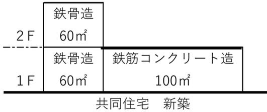
1階床面積 鉄骨造 < 鉄筋コンクリート造
