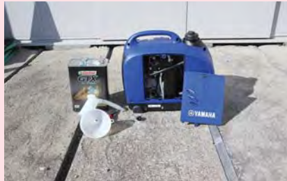
発電機オイル交換
