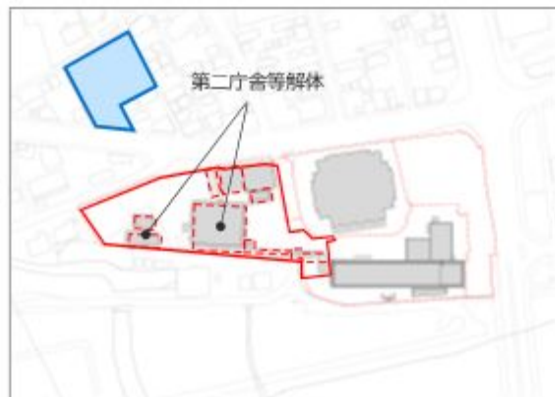
STEP1) 第二庁舎等解体工事
